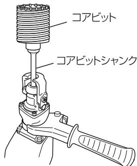
② 機体からコアビットシャックをはずしてコアビットを手で持ち、コアビットシャックの頭を手ハンマで2～3回強打すると、丸ねじがゆるみ、取りはずすことができます。
